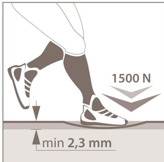
Деформация спортивного покрытия при динамическом воздействии в 1500N. Рассматривается в комплексе с абсорбцией удара. Оптимальный диапазон 2,3...5 мм.
