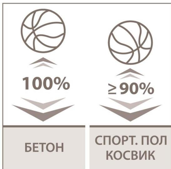
Актуальный фактор для игр с отскоком мяча. Испытания заключаются в сравнении отскока стандартно накачанного баскетбольного мяча на спортивном покрытии и на бетонной плите. Должен составлять не менее 90% от отскока на бетоне.
